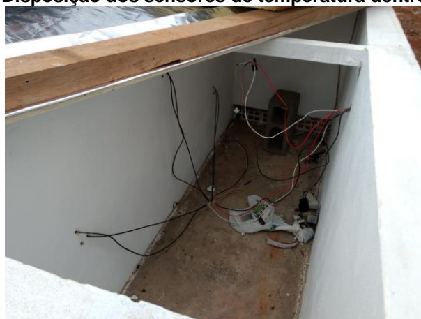
Figura 11 – Disposição dos sensores de temperatura dentro do módulo.
