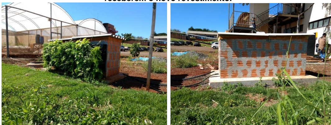
Figura 5 – Modelos reduzidos (escala 1:12) com e sem parede verde na fachada norte, antes de receberem o novo revestimento.
