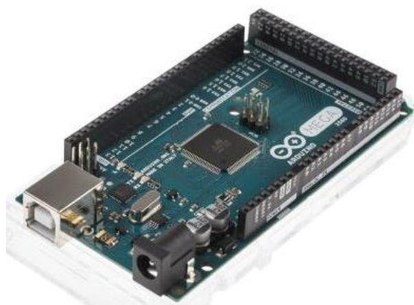
**Figura 5 - Placa do Arduino Atmega 2560**
