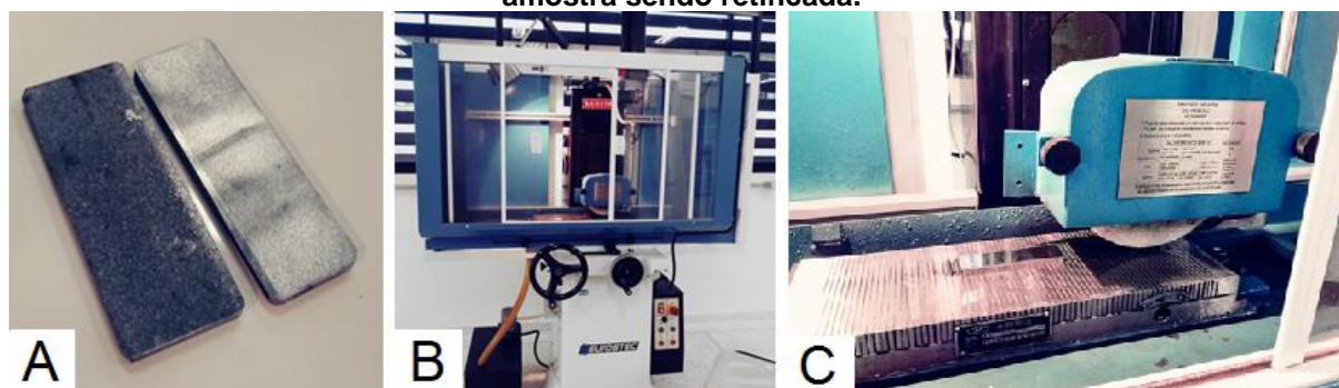
Figura 10 – (A) Amostras antes do processo de retificação, (B) retificadora utilizada, (C) amostra sendo retificada.
