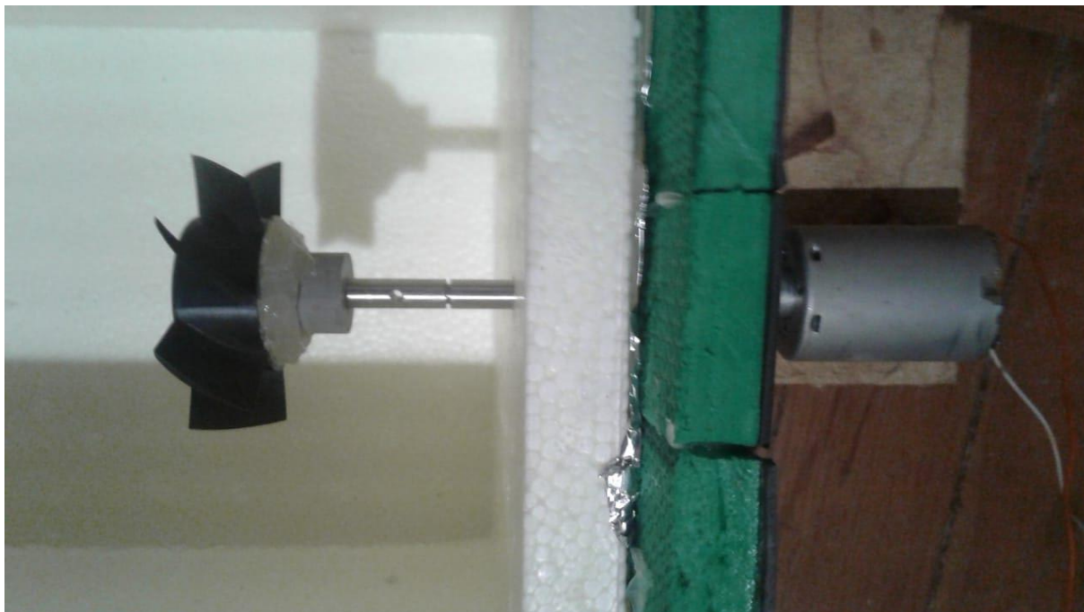
Figura 38 – Cooler para circular o ar na parte interna do refrigerador. Fonte: Autor.
