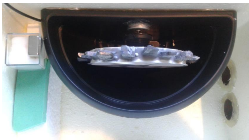
Figura 29 – Vista superior do motor de gadolínio acoplado com o Motor DC. Fonte: Autor.
