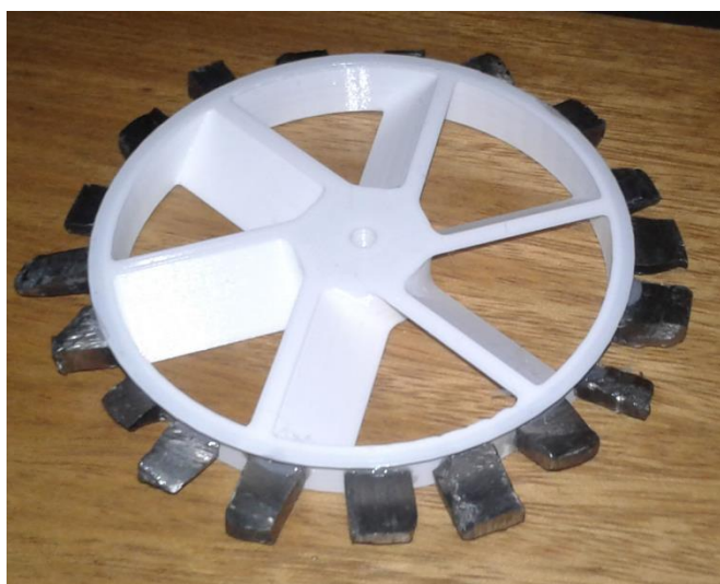
Figura 16 - Parte parcial do motor de gadolínio. Fonte: Autor.
