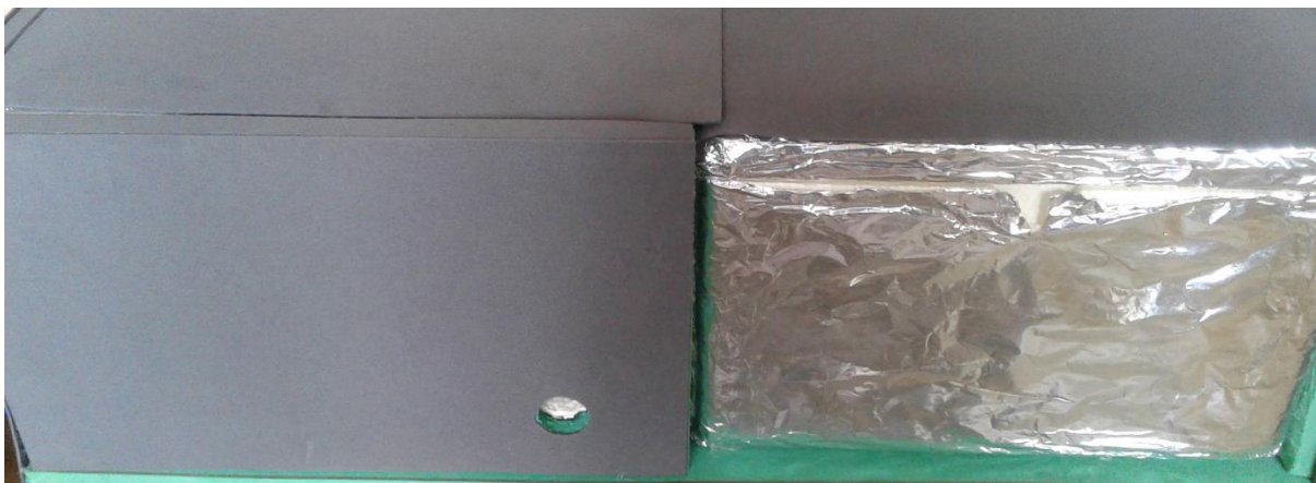
Figura 21 - Caixas de isopor revestidas com papel alumínio e EVA. Fonte: Autor.
