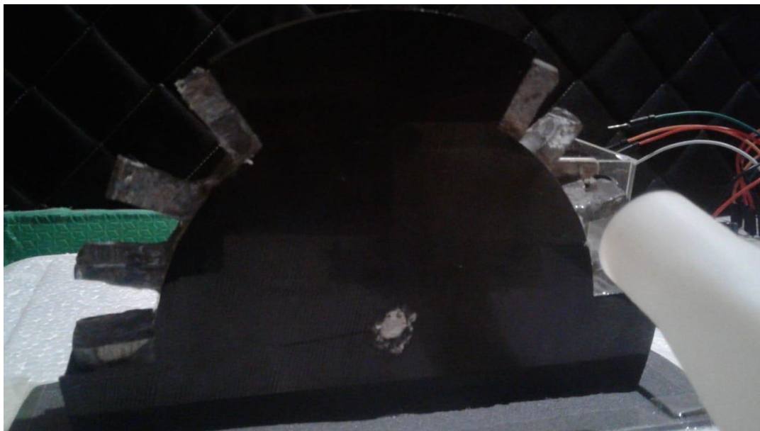
Figura 36 – Vista lateral do motor de gadolínio. Fonte: Autor.
