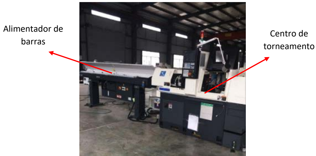
Figura 42 - Alimentador de barras montado em conjunto com um centro de torneamento (Wanda-an n.d.).
