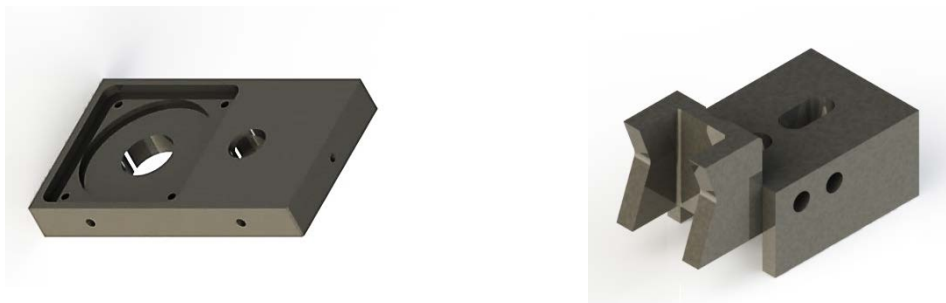
Figura 6 – Peças que serão fabricadas por fresagem.
