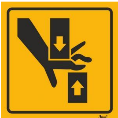
Figura 110 - Perigo de esmagamento e amputação causado por dois componentes móveis.
