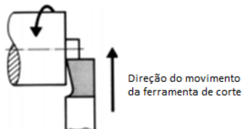
Figura 19 - Direção de corte no facejamento. Adaptado de (Tschätsch, 2009).
