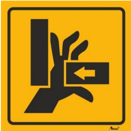
Figura 109 - Perigo de esmagamento e amputação causado por um componente móvel.
