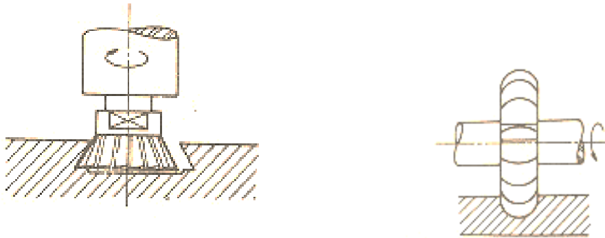
Figura 8 - Fresagem cilíndrico tangencial. (Trent & Wright, 2000).
