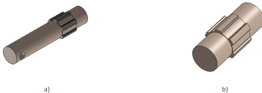
Figura 75 – Eixos das engrenagens utilizando acoplamento por estrias. a) Eixo da coroa; b) eixo do pinhão.
