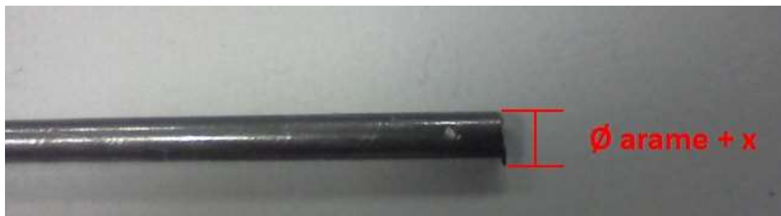
Figura 35 - Arame com rebarba. Fonte: Elaborado pelo autor (2017).
