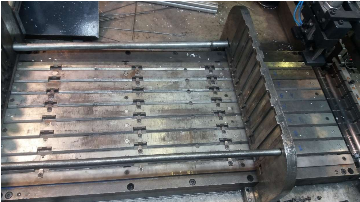
Figura 30 - Réguas e línguas antigas do carregador de arame do posto das espinhas. Fonte: Elaborado pelo autor (2017).
