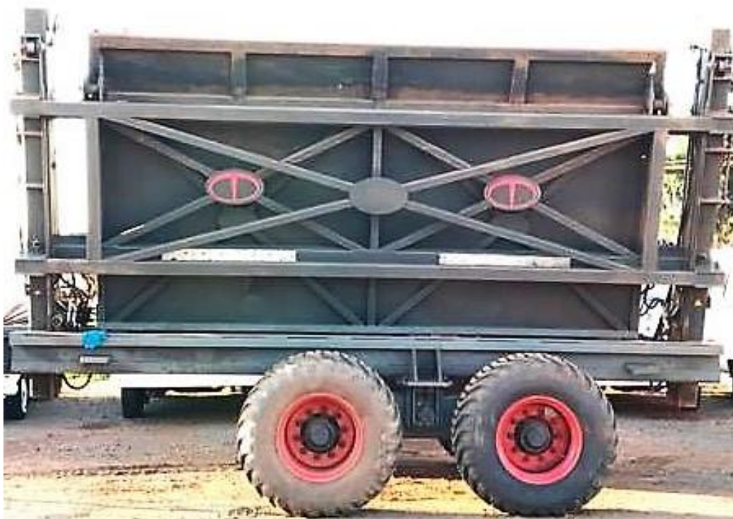
Figura 5 – Transbordo MCT 10500 e seus reforços na estrutura Fonte: Autoria Própria
