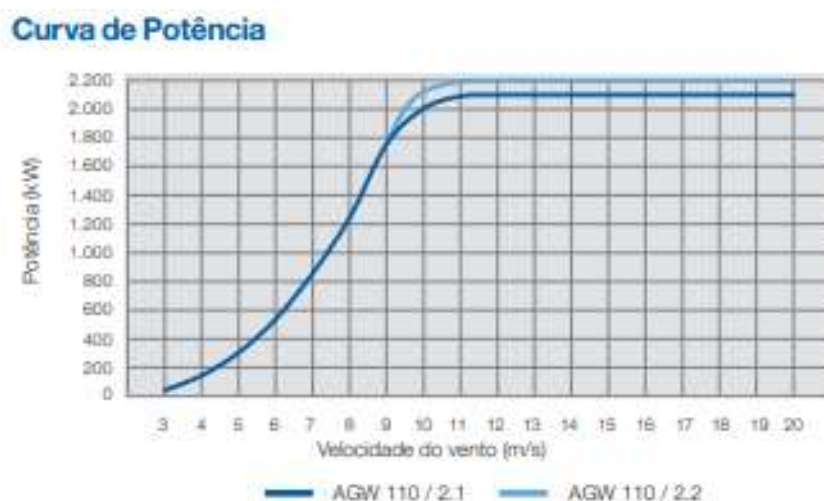
Figura 14 – Curva de potência do aerogerador WEG AGW 110/2.1.
