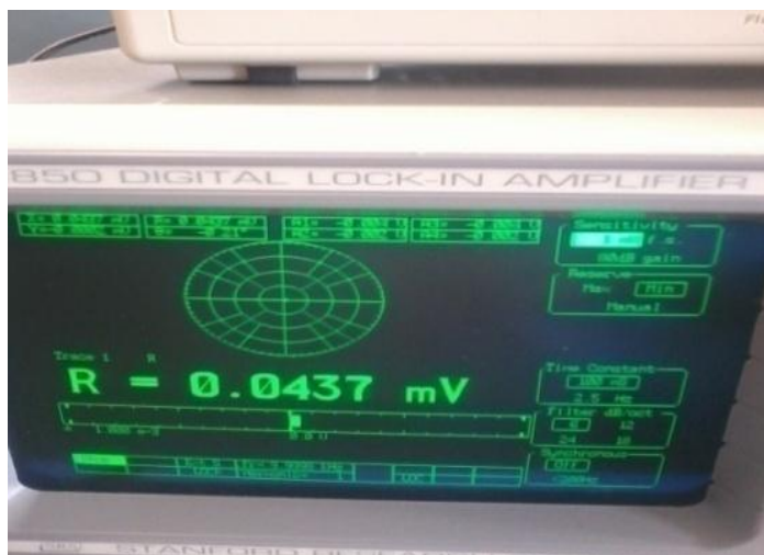
Figura 60 - Valor obtido para o DUT usando o SR850.
