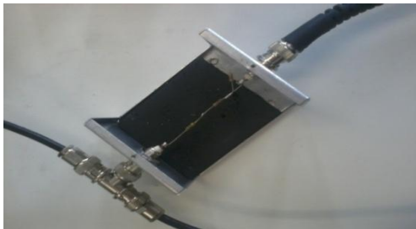
Figura 59 – Circuito e equipamento DUT para teste do SR850.
