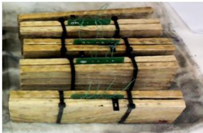
Figura 70 - Quatro “sanduíches” dos sensores com as amostras das madeiras.
