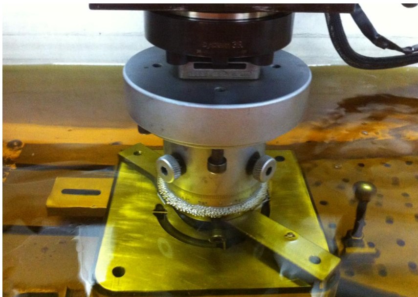
Figura 12 - Exemplo de uso do fluido dielétrico em EDM, óleo hidrocarboneto.
