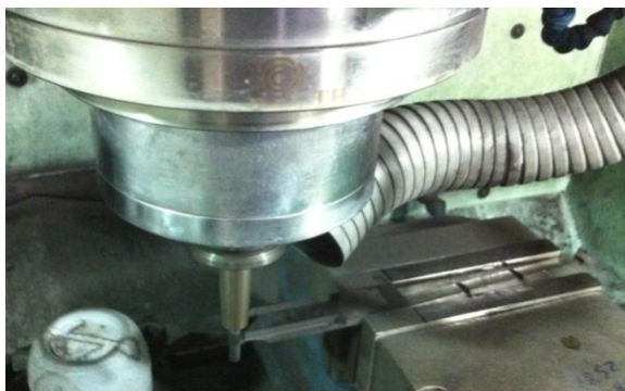
Figura 29 - Centro de usinagem com proteção de guias e fusos, específico para grafite.
