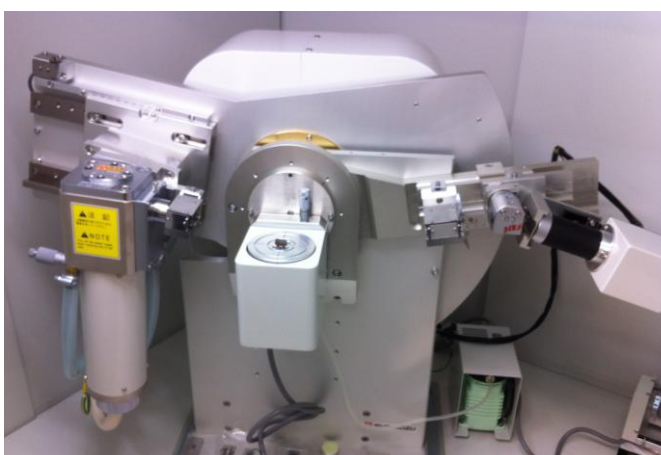
Figura 26 - Difratômetro de raio x \text{CuK}\alpha para análise da superfície do eletrodo após usinagem.
