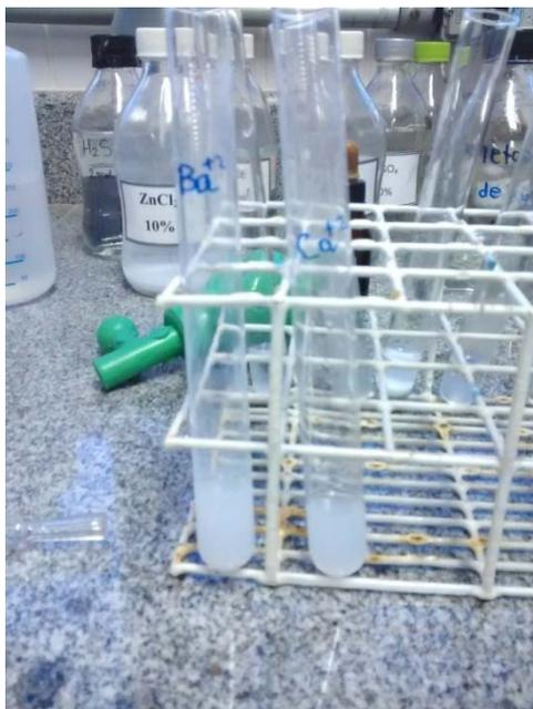
**Fotografia 3: Resultado da substituição do hidróxido de bário (primeiro tubo) por hidróxido de cálcio (segundo tubo).**
