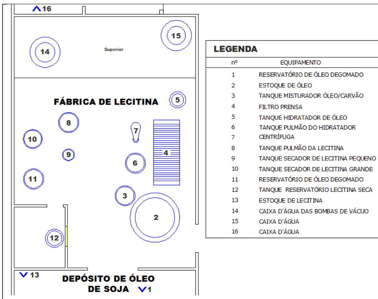
Figura 06– Layout da disposição dos equipamentos no processo de produção da lecitina de soja.
