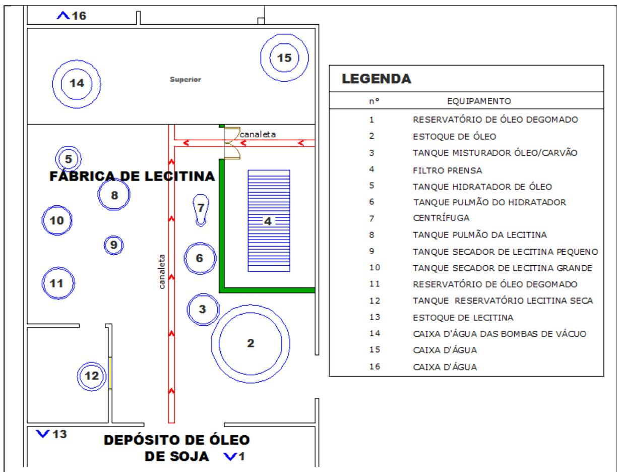
Figura 09 – Separação da área suja (filtro prensa) da área limpa de produção.
