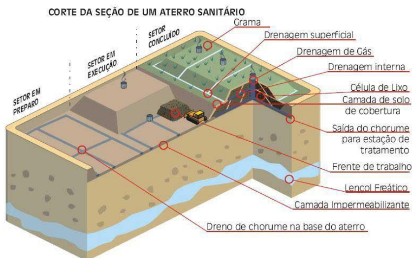
Figura 1. Estrutura básica de um aterro sanitário
