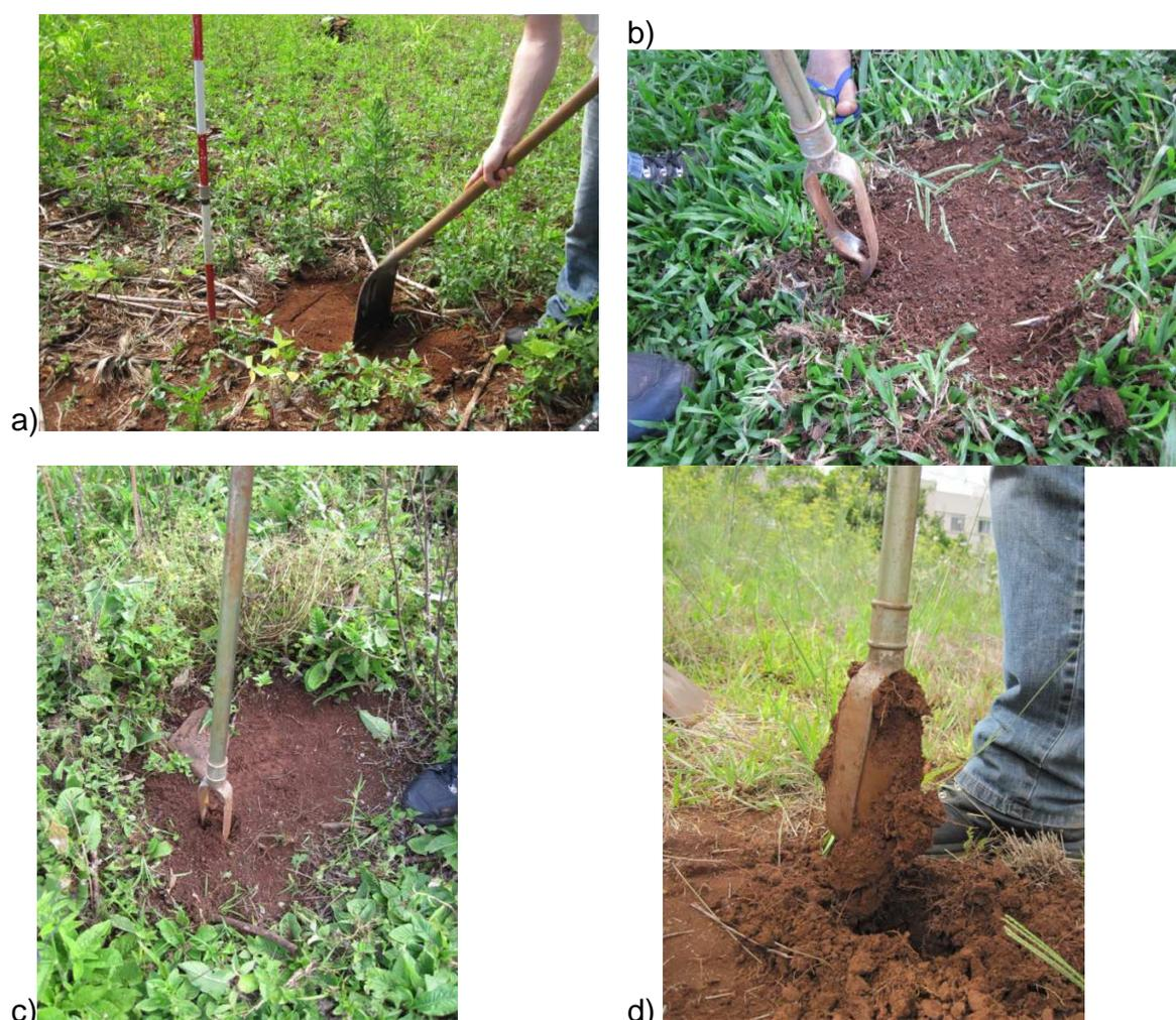
**Figura 15 - Coleta de amostra de solo: a) limpeza superficial; b) trado holandês; c) coleta da amostra; d) amostra de solo coletada.**
