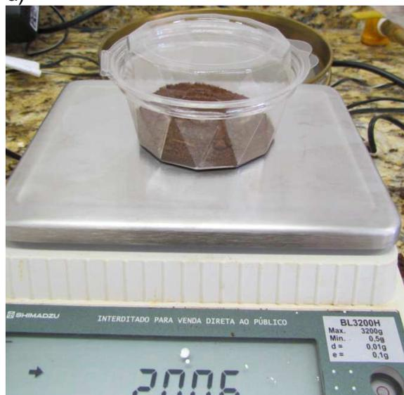
Figura 17 - Análise granulométrica: a) solo preparado e pesado; b) agitador ro-tap e peneiras; c) frações do solo separadas; d) amostra de solo para segunda análise.
