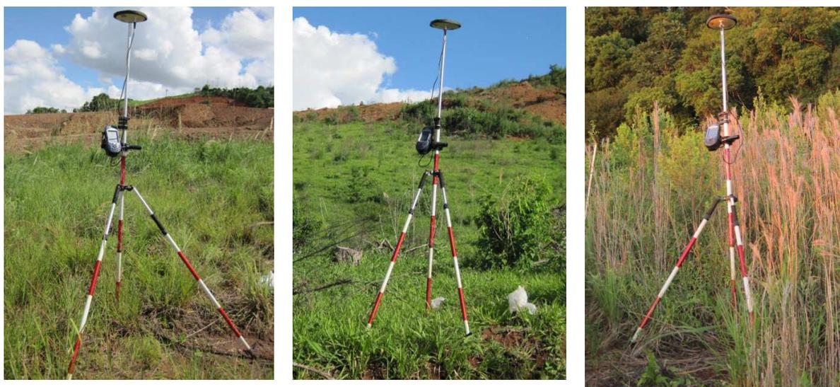
**Figura 11 - Georeferenciamento de pontos de coleta com GPS.**
