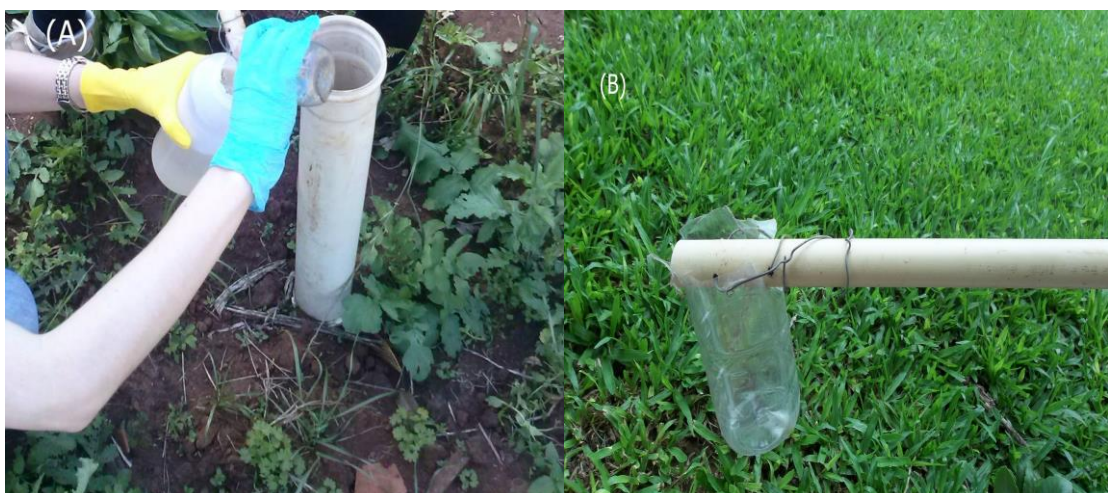
Figura 5. (A) Ponto de coleta do esgoto bruto. (B) Equipamento de coleta.
