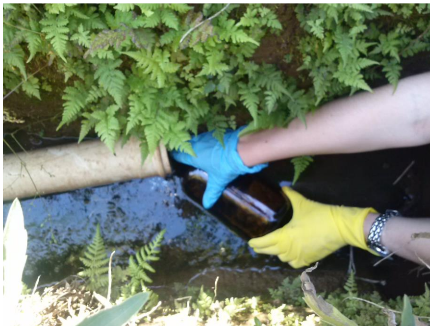
Figura 6. Ponto de coleta do esgoto tratado.
