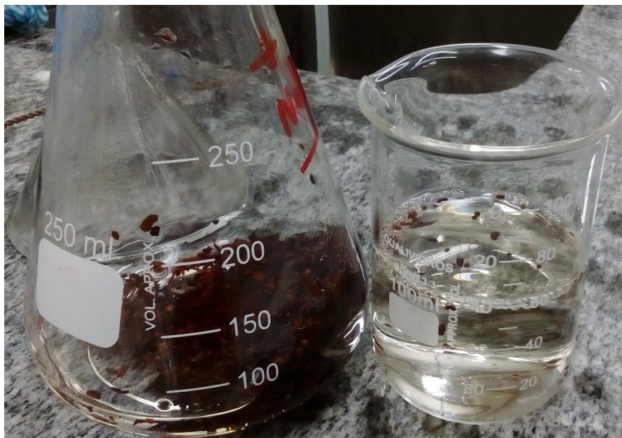
Figura A.3: 1º teste para o tratamento químico – casca em contato com HCl
