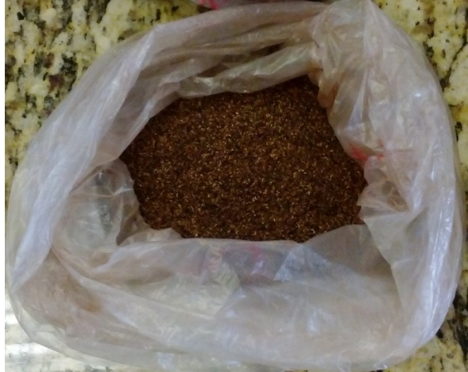
Figura A.2: Casca de pinhão após passar pelo processo de granulometria. Fração que foi utilizada nas análises.
