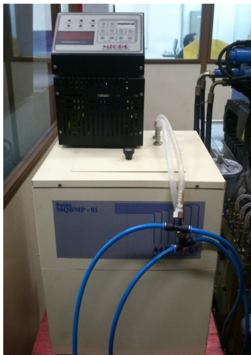
Figura 3.6 – Equipamento de banho termostático utilizado para alcançar as diferentes temperaturas do molde.
