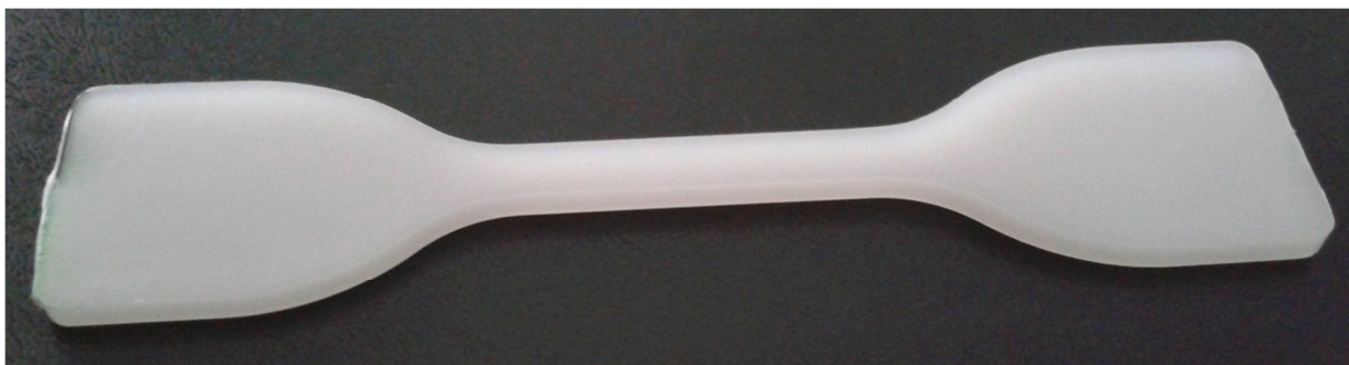
Figura 4.2 – Corpo de prova de PP obtido após alteração do curso de fechamento e aumento das pressões de injeção e recalque.
