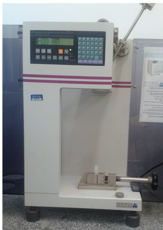
Figura 3.11 – Aparelho Ceast resil 5.5 utilizado para ensaio de impacto Izod.
