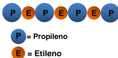
Figura 2.8 – Representação da estrutura molecular do PP copolímero randômico (Adaptado de Callister, 2007).
