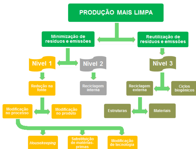
Figura 2 - Abordagem esquemática da Produção mais Limpa Fonte: Adaptado de CNTL (2002).
