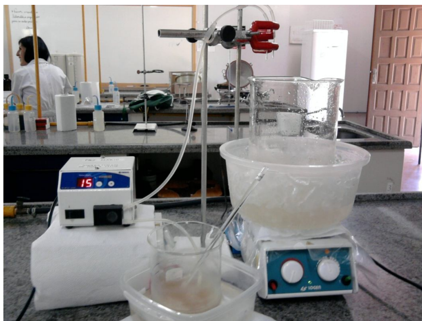
Figura 7 - Esquema para o gotejamento da solução de PVA+AS em solução de \text{CaCl}_2 Fonte: Própria.
