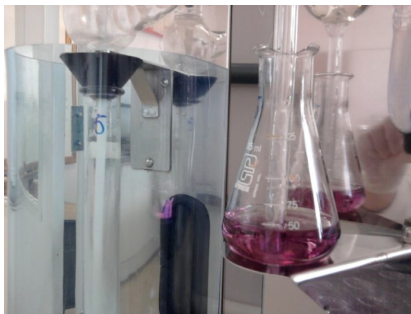
Figura 24 - Coloração roxa da solução indicadora ácido bórico no destilador micro-Kjeldahl Fonte: Própria.
