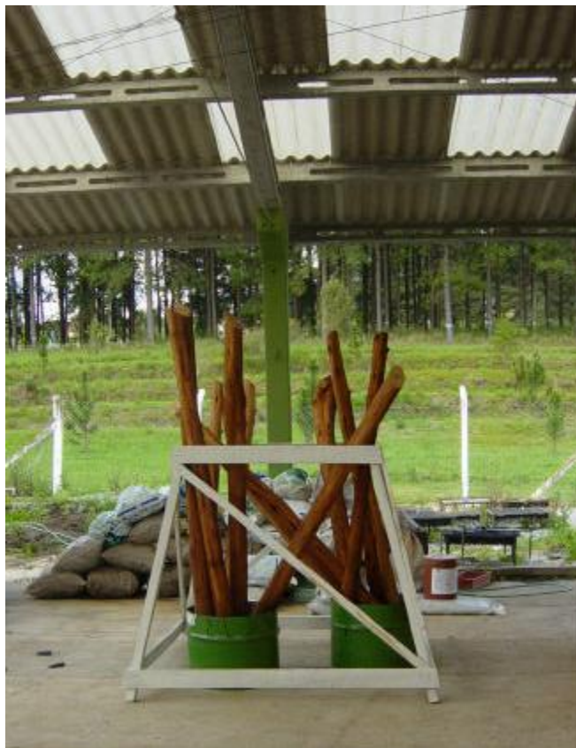
Figura 1. Tratamento de mourões pelo método de substituição de seiva. Fonte: Magalhães e Pereira, 2003.
