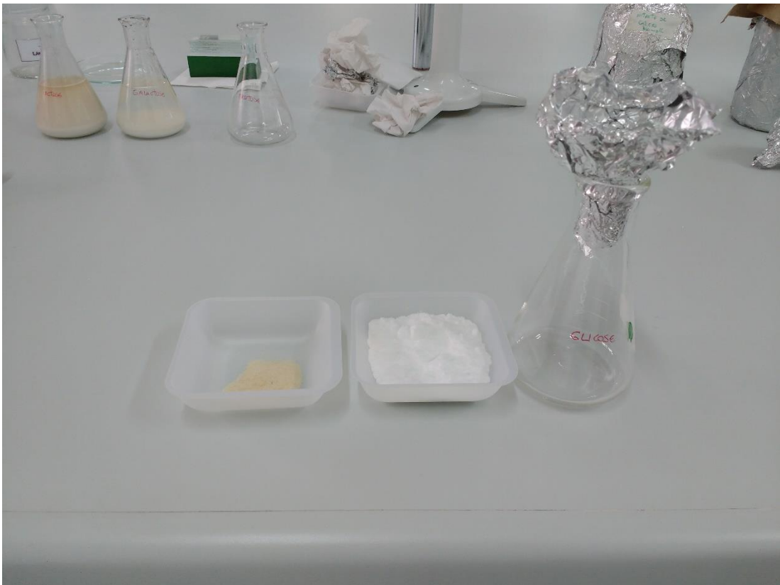
Figura 1 - Pesagem dos materiais utilizados, 0,8 g de ágar e 30 g de cada açúcar, para cada um dos cinco meios testados. Fonte: A autora, 2016.
