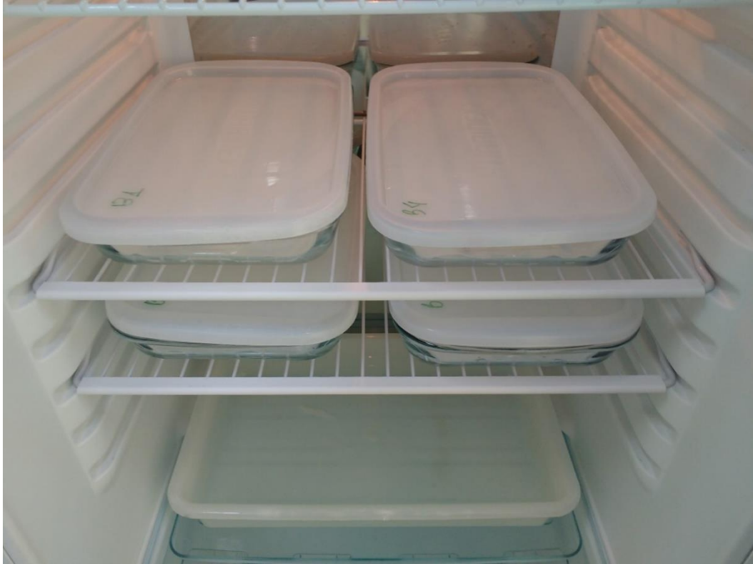
Figura 3 - Cubas de vidro representando os blocos, dentro da BOD, com umidade e temperatura controladas. Fonte: A autora, 2016.
