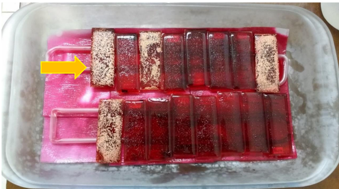
Figura 6 - Lâminas com açúcar lactose, representadas pela seta, e com atividade fúngica sobre as mesmas. Fonte: A autora, 2016.
