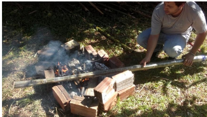
Figura 9: Termo fundição ao fogo. Fonte: O Autor, 2015.
