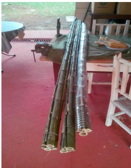
Figura 8: Estruturas com e sem revestimento. Fonte: o Autor, 2015.
