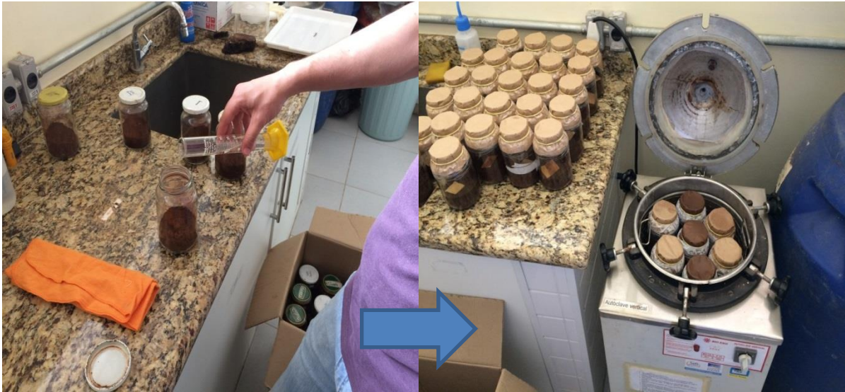
Figura 4 e 5: A foto a esquerda 4 representa o momento da adição de água destilada, a foto a direita 5 mostra como os vidros foram dispostos na autoclave para a esterilização (O autor, 2017).
