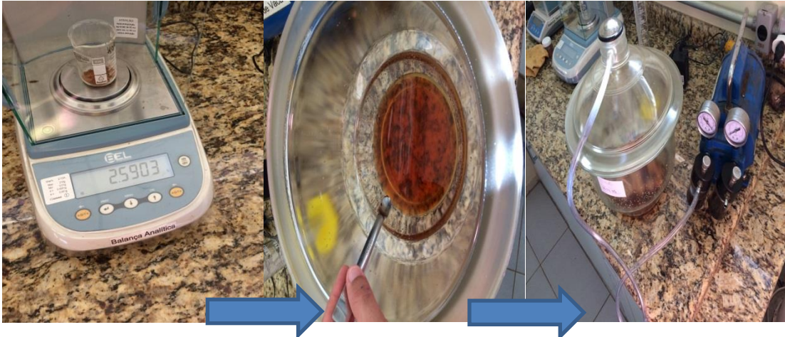
Figura 6, 7 e 8: A imagem a esquerda 6 mostra a quantidade (gramas) pesada do polímero, a imagem central 7 mostra a solução com o polímero já diluído, e a imagem a direita 8 o processo de difusão simples (O autor, 2017).
