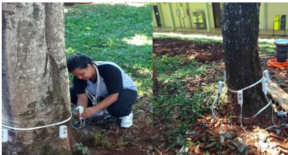
Figura 10 -Instalação dos sensores para Tomografia de impulso no tronco Magnólia-amarela ( Michelia champaca ) e Ipê-Roxo ( Handroanthus avellanedae ). Fonte: Do Autor (2018).
