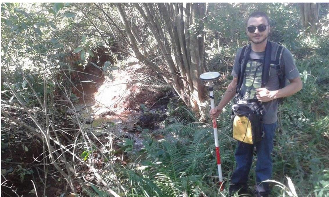
**Figura 16 - Uso do GPS para captação das coordenadas dos pontos onde localizam-se as trincheiras a 0, 5 e 10 m distantes do córrego.**
