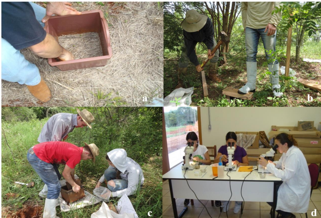
Fotografia 5 - Coleta de macrofauna edáfica pelo método TSBF: a coleta de serapilheira, b) coleta de solo, c) retirada do monólito de 20 cm de profundidade; d) identificação dos indivíduos com auxílio de microscópio estereoscópico.
