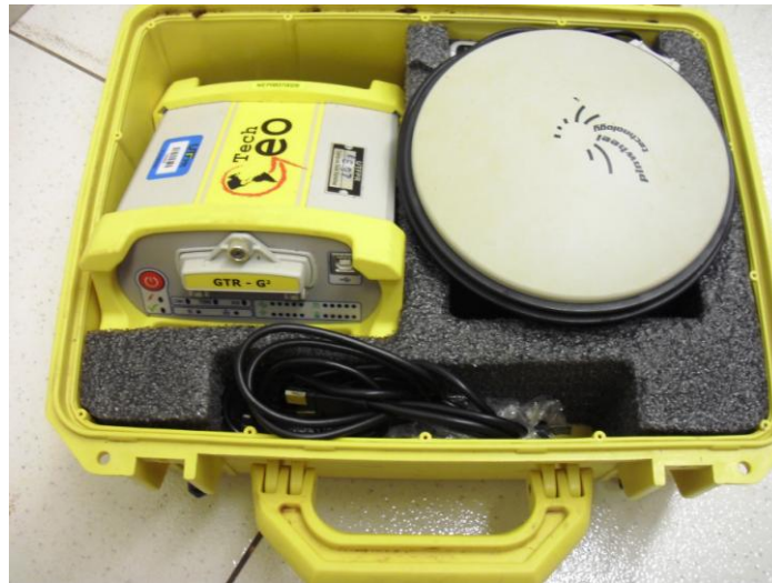
Fotografia 3 – Modelo de GPS geodésico Fonte: O autor
