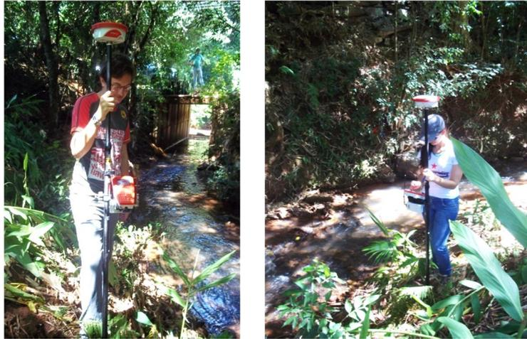
**Fotografia 01: Determinação dos pontos com auxílio de um GPS de precisão.**
