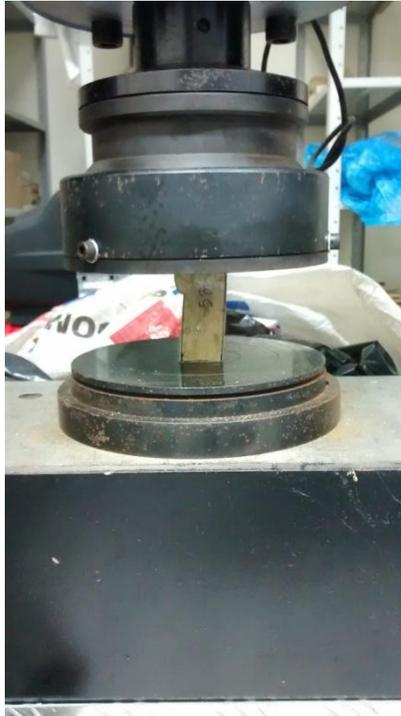
**Figura - 2: Ensaio de resistência à compressão paralela as fibras**
