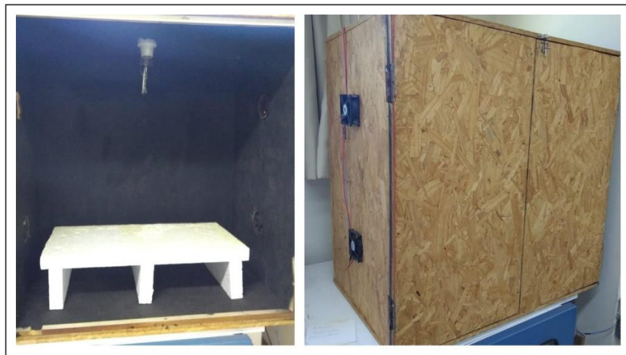
Figura 9 – Caixa escura contendo uma lâmpada UV (125 W) de vapor de mercúrio, imagem à esquerda representa a caixa aberta e a imagem a direita mostra a caixa fechada, sua proporção e sistema de ventoinhas
