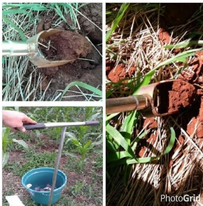
Figura 2. Coleta de solo utilizando trado holandês. Fonte: Autor, 2015.
