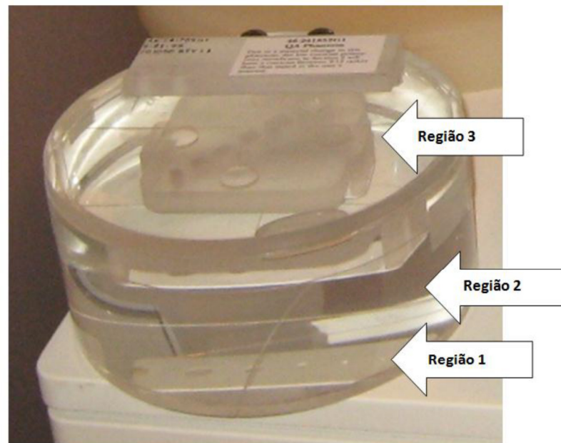
Figura 18 – Objeto simulador usado para testes de controle de qualidade, com as especificações das regiões para análise da qualidade da imagem.
