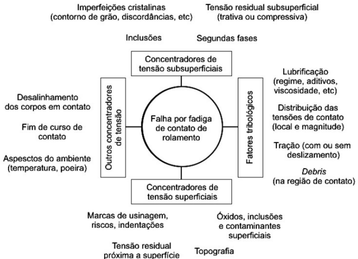
**Figura 1- Fatores que podem influenciar a vida em fadiga de um material.**
