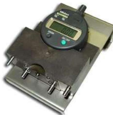
**Figura 14- "Almen Gauge" - Dispositivo para medir a deflexão das plaquetas.**
