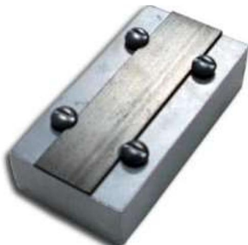
**Figura 13- Bloco padrão para fixação das plaquetas padronizadas.**
