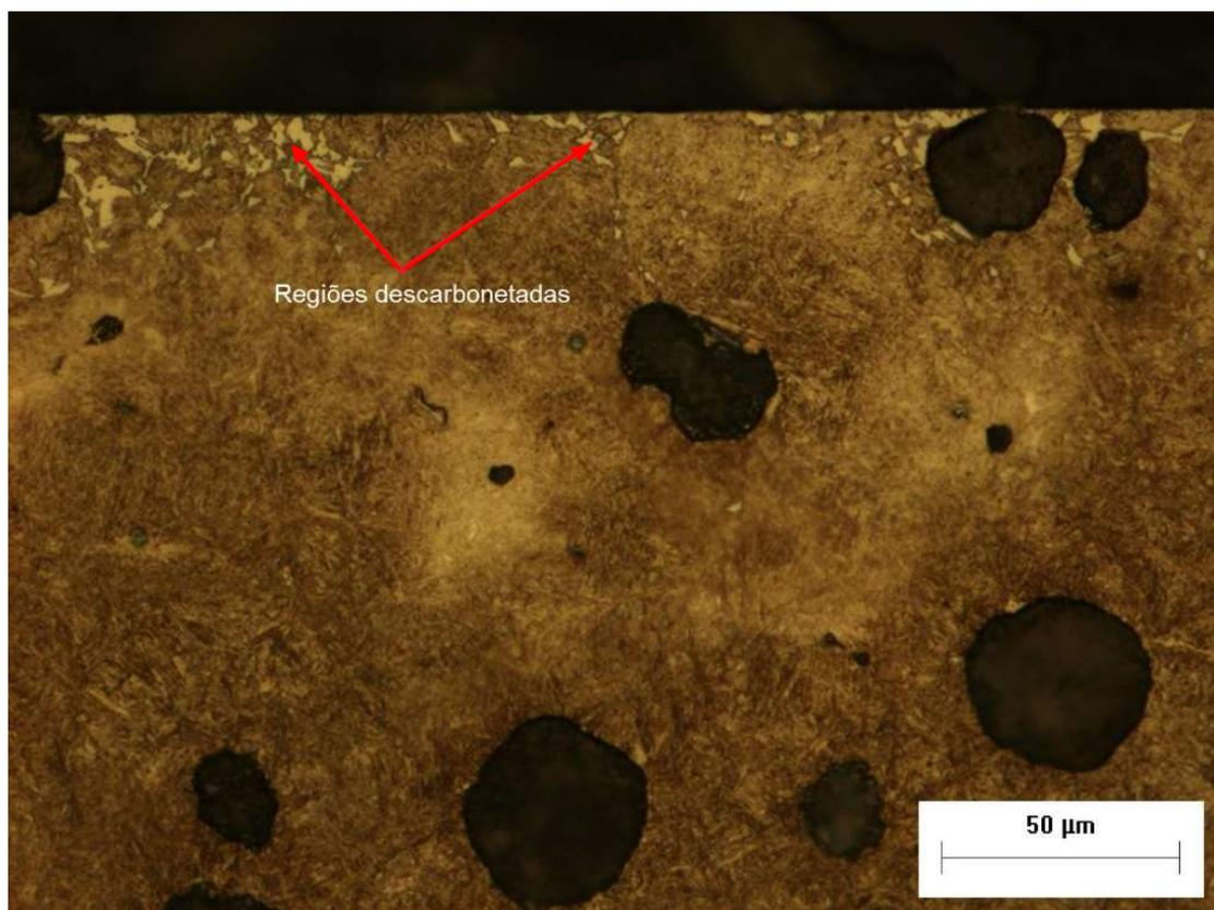
**Figura 47- Região descarbonetada CP3.**
