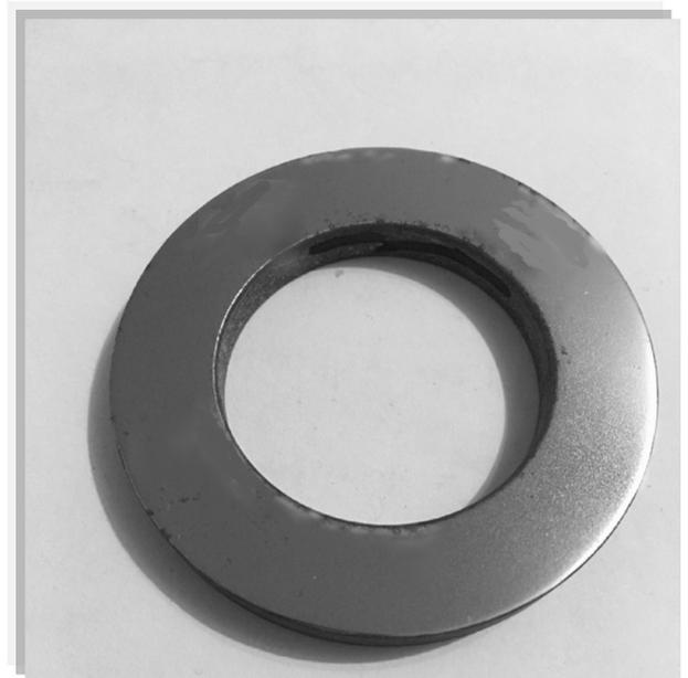
**Figura 37- Corpo de prova polido**
