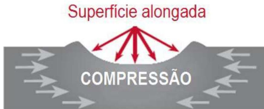
**Figura 7- Camada uniforme de tensões residuais compressivas gerada abaixo das concavidades criadas pelo impacto das granalhas.**
