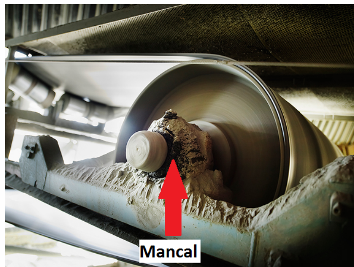
Figura 1.3: Exemplo de um mancal exposto a detritos do ambiente externo.
