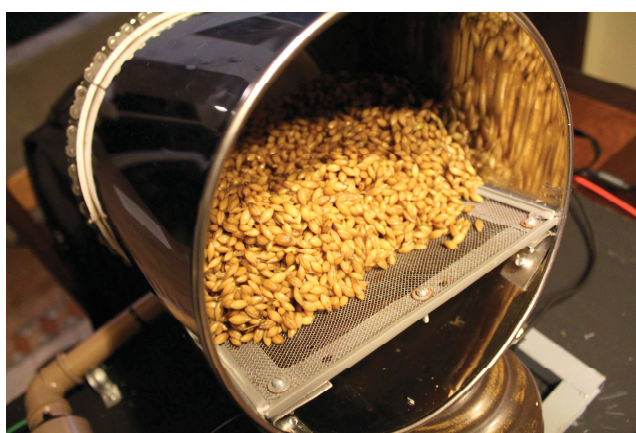
Figura 52– Protótipo do tambor de germinação. Fonte: Autores.
