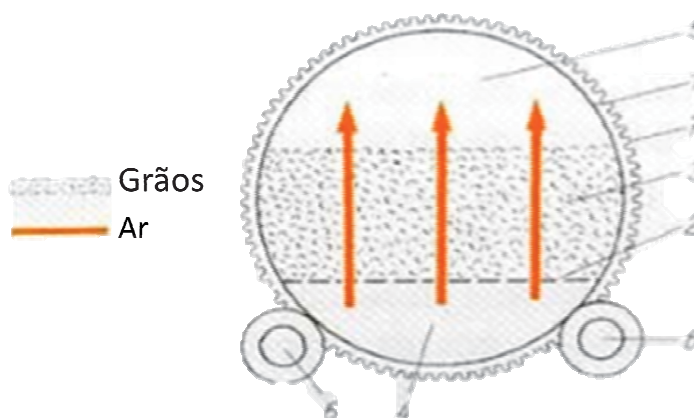
Figura 11 – Exemplo de Tambor de Maceração. (1) Cilindro de chapas de aço, (2) fundo falso, (3) Malte verde, (4) Ar umidificado, (5) Ar de exaustão, (6) Transmissão
