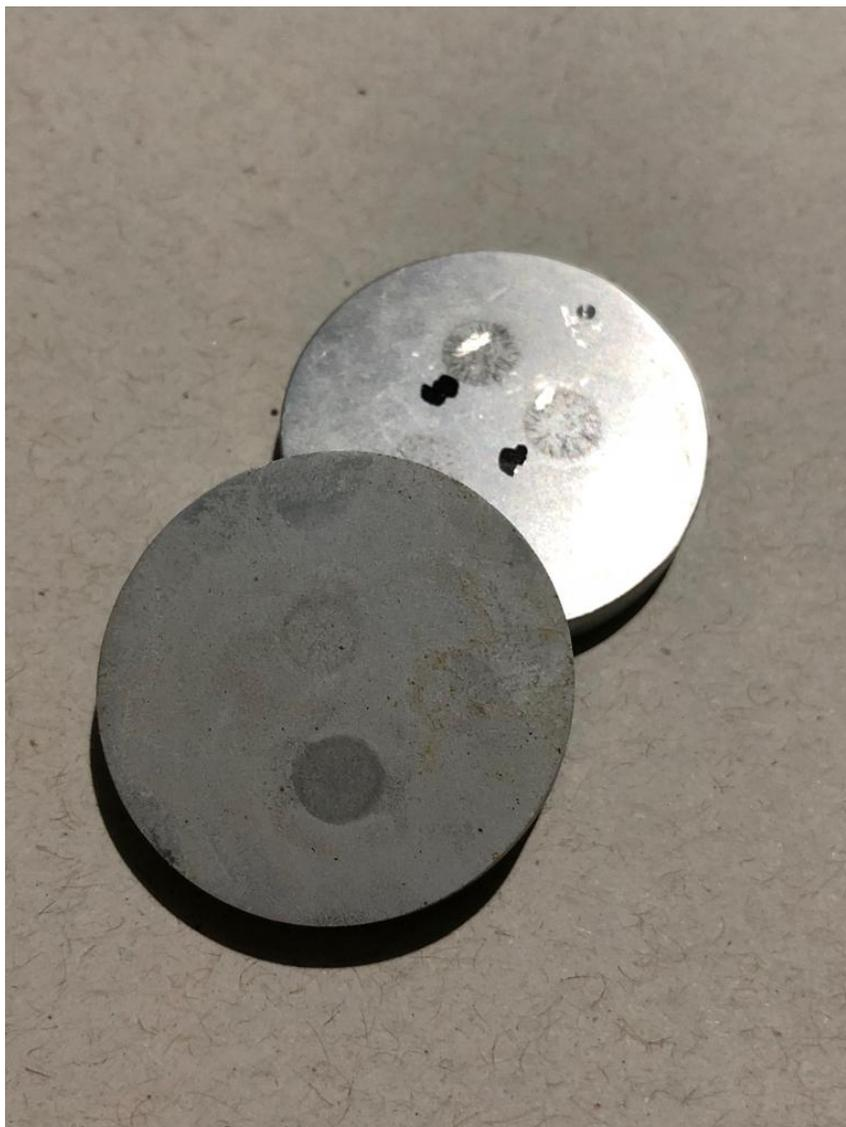
Figura 22 – Áreas tratadas pela oxidação eletrolítica a plasma
