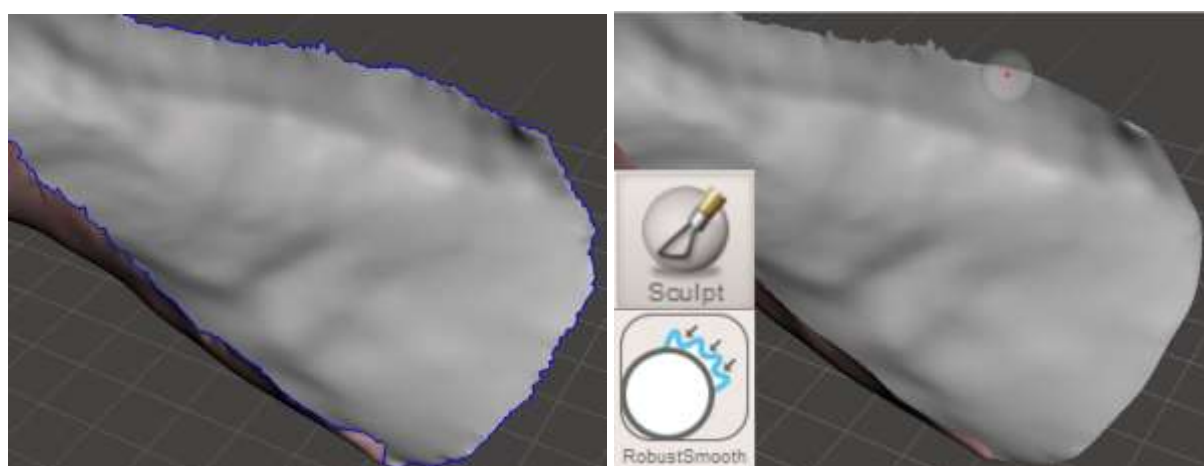
Figura 27 - Exemplo da aplicação da ferramenta "RobustSmooth" na suavização do contorno da malha.
