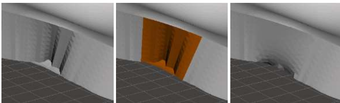
Figura 29 - Exemplo de correção de um defeito de borda após a extrusão.
