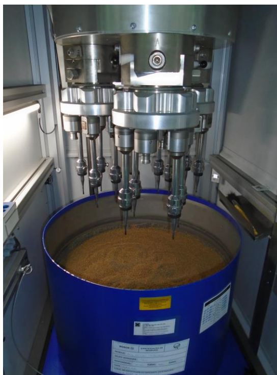
Figura 27 - Exemplo de uso da máquina Drag Finishing com o abrasivo 1/300 Fonte: Autoria própria
