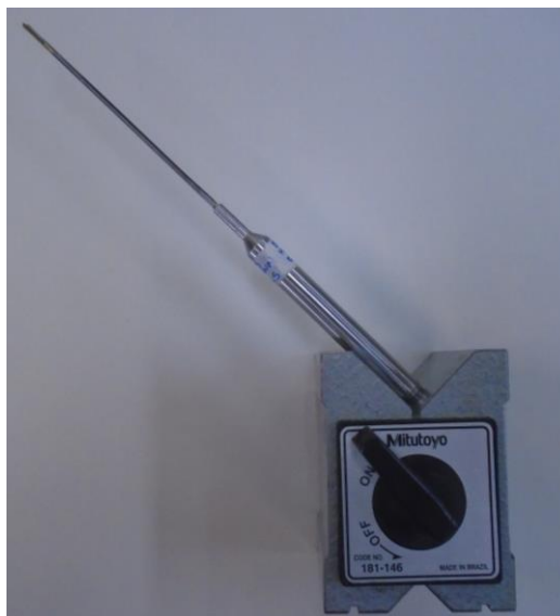
Figura 33 - Posicionamento da ferramenta para medição em rugosímetro.
