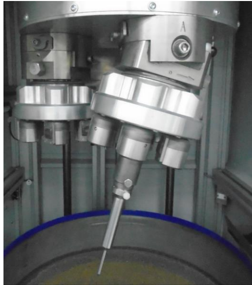
Figura 32 - Ferramenta montada no equipamento Drag Finishing
