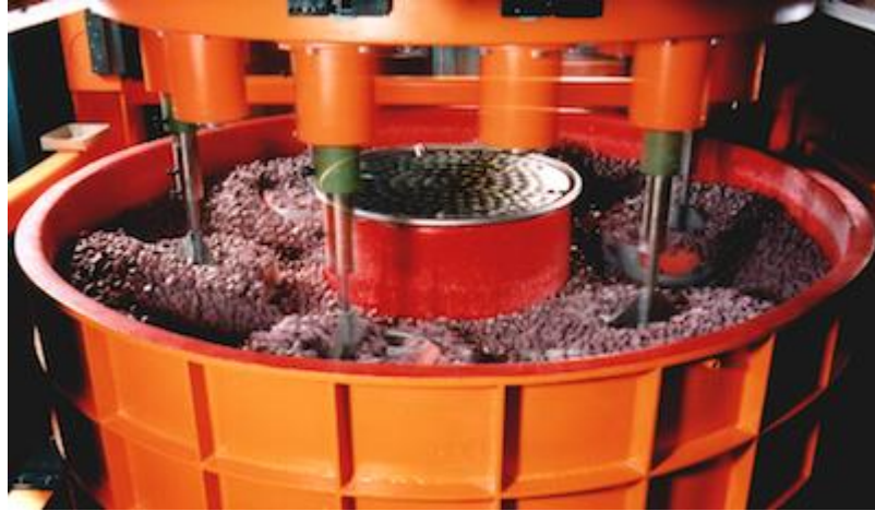
Figura 18 - Exemplo de ferramentas em um processo Drag Finishing Fonte: advancedfinish.com
