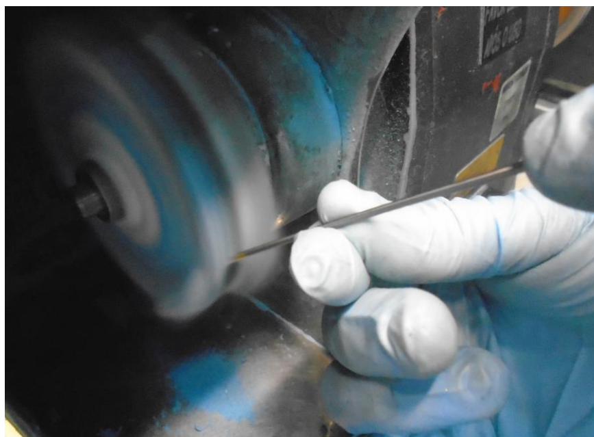
Figura 30 - Execução do processo de arredondamento manual. Fonte: A autoria própria.
