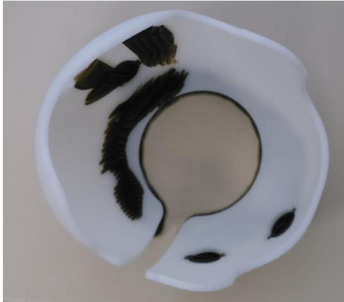
**Figura 26 - Vista inferior do capacete antes da retirada do material de suporte.**
