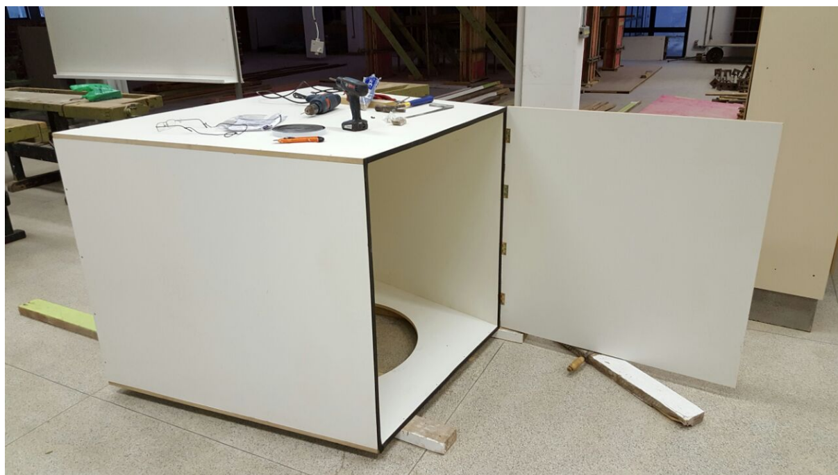
Figura 4.8 – Câmara reverberante em escala reduzida após etapa de parafusamento das chapas.
