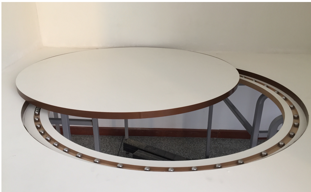
Figura 4.3 – Mesa giratória e pista de atrito por rolamento.
