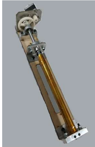
Figura 19 – Cabeçote Extrusor desenvolvido.
