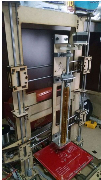
Figura 20 – Montagem do cabeçote extrusor na impressora 3D
