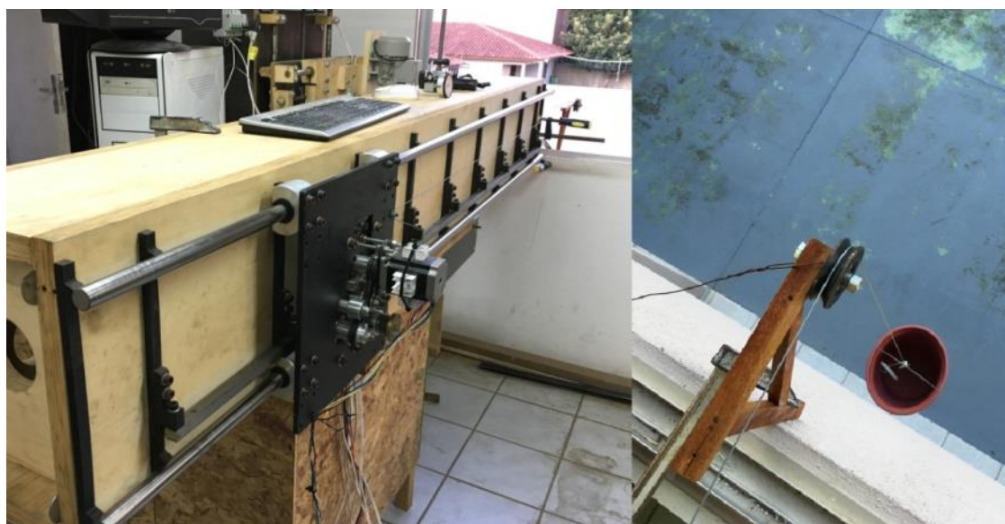
Figura 33 – Solução de validação para aplicar força constante no carro. Fonte: Autoria própria
