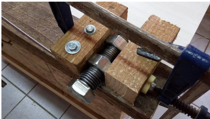
Figura 23 - Fabricação da mola de torção Fonte: Autoria própria
