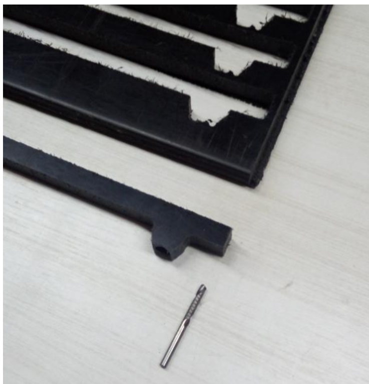
Figura 22 - Suporte usinado em Router CNC Fonte: Autoria própria
