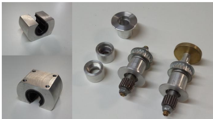
Figura 26 - Componentes dos eixos e esticadores fabricados. Fonte: Autoria própria
