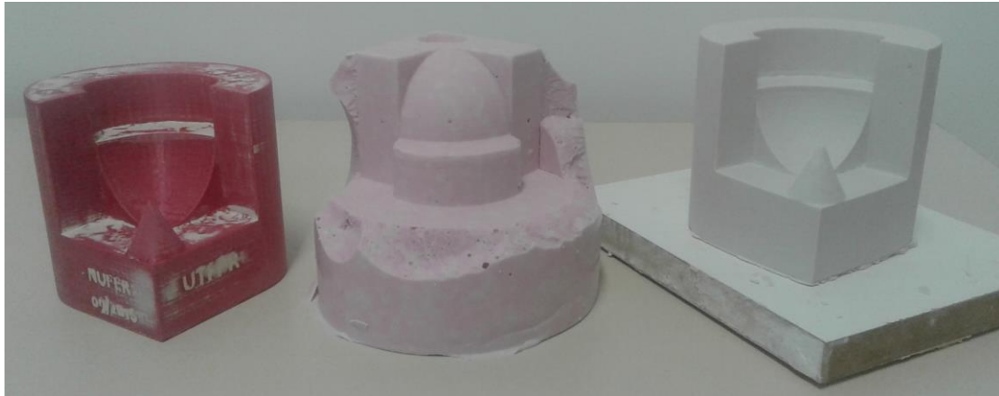
Figura 16: Corpo de prova original, molde de alginato bipartido e corpo de prova em gesso.
