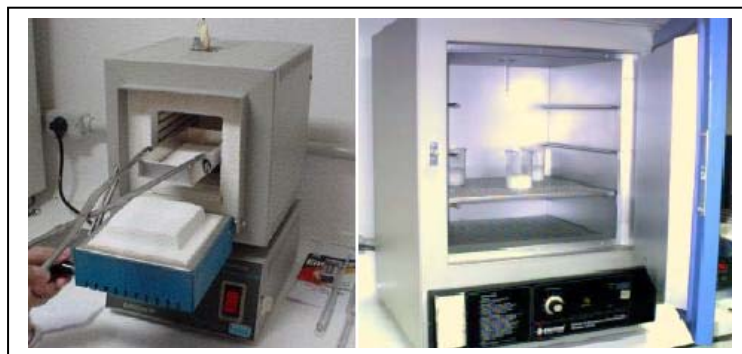
Figura 12: Colocação do pó TL no forno e secagem na estufa.
