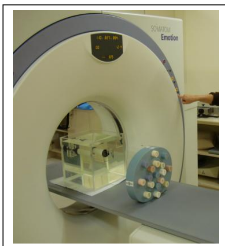
Figura 23: Obtenção da imagem tomográfica do arranjo experimental com a heterogeneidade.
