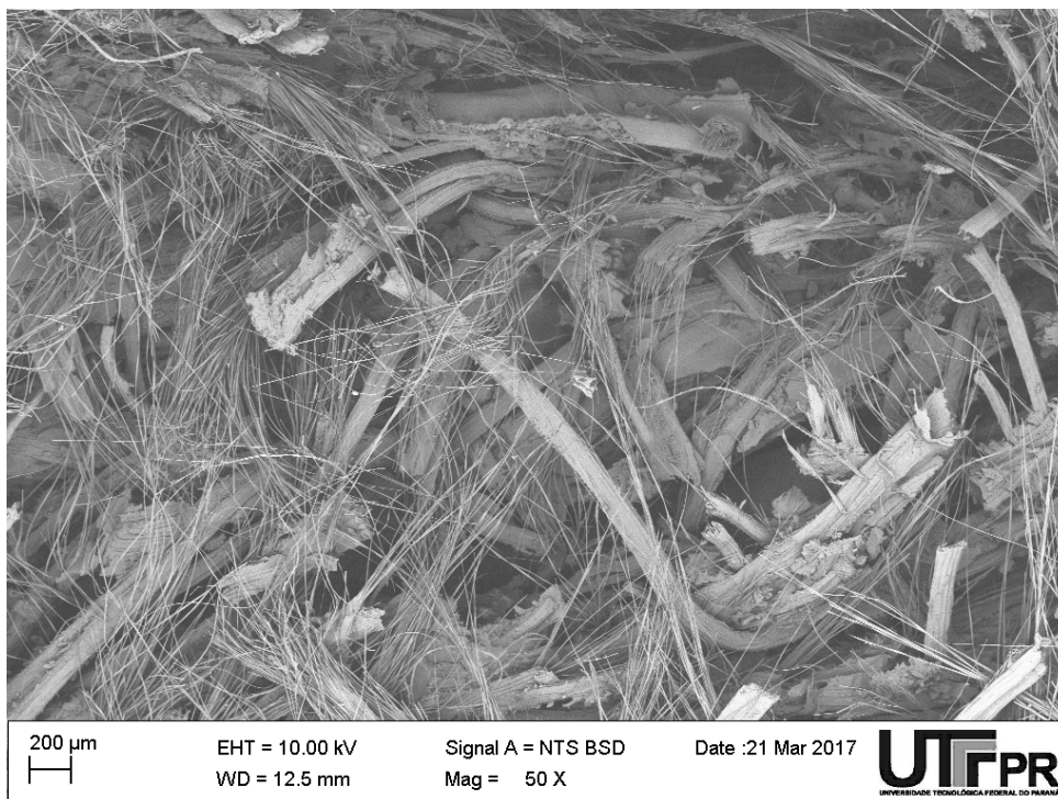
Figura 32 – Micrografia do MEV de uma amostra 75 °C 60% 4,3MPa
