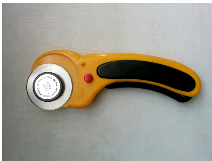
Figura 16 – Lâmina circular utilizada no corte das fibras
