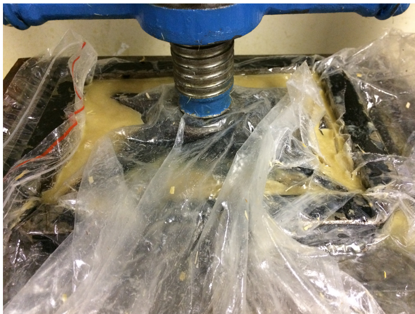
Figura 13 – Poliuretano vazando sobre o molde durante a fabricação de uma placa de compósito
