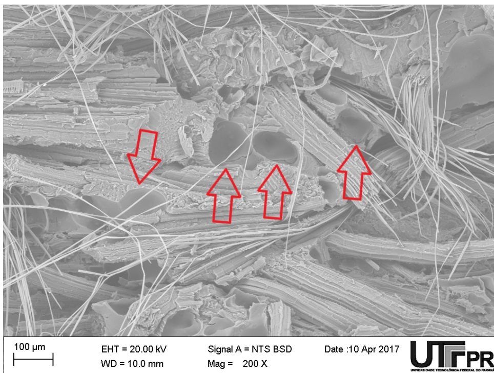
Figura 34 – Micrografia do MEV de uma amostra 60°C 50% 1,3MPa
