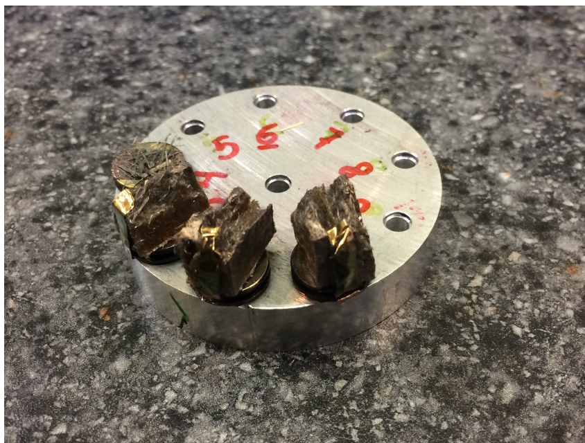
Figura 12 – Amostras metalizadas antes do MEV
