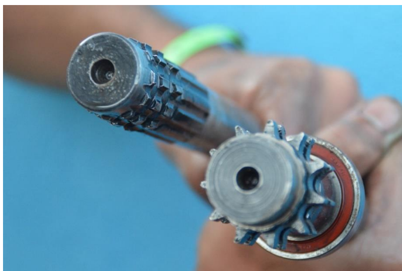
Figura 4 – Fotografia do 1º eixo com dentes fraturados devido fragilização. Fonte: Equipe Imperador UTFPR (2016)
