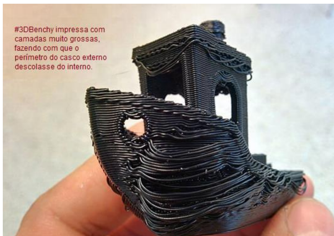
Figura 11 - Peça impressa com vazão de material acima do requerido (ALL3DP, 2016)
