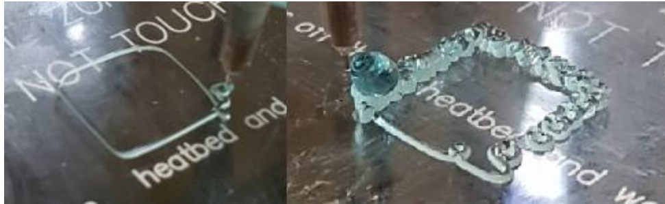
Figura 33 – Velocidades inadequadas de extrusão. a) Baixa velocidade de extrusão; b) alta velocidade de extrusão
