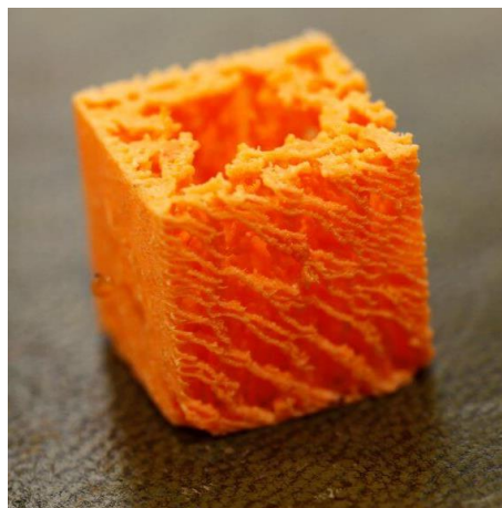
Figura 12 - Peça impressa com vazão de material abaixo do requerido (ALL3DP, 2016)
