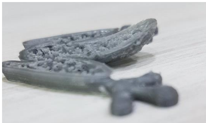
Figura 14 - Peça em PLA deformada devido à falta de ventilação (Autoria própria)
