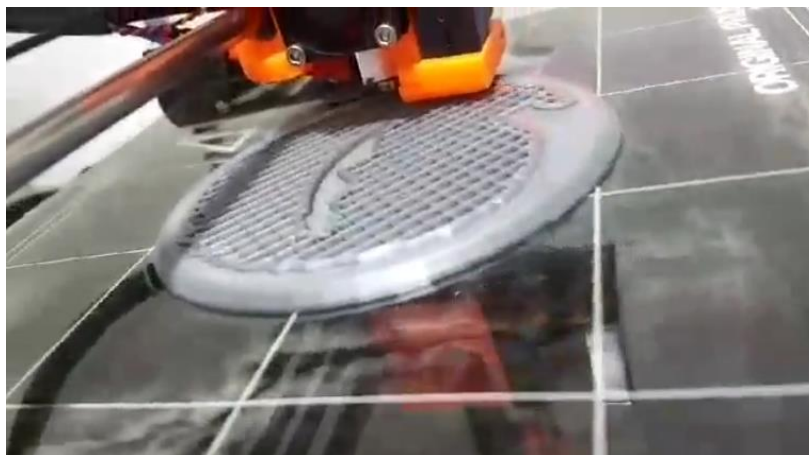
Figura 8 - Processo de fabricação de uma peça por manufatura aditiva (Autoria própria)
