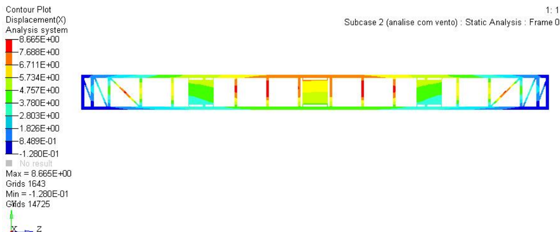
Figura 14 – Deslocamentos horizontais da viga original (em mm)
