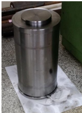
Figura 9: Dispositivo de testes desenvolvido para envelhecimento mecânico da graxa.
