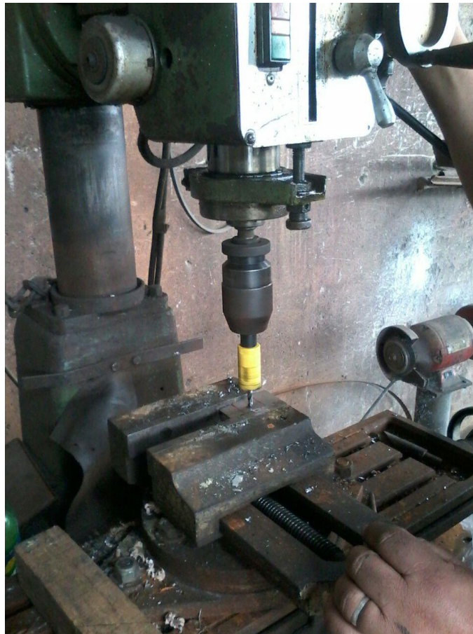
Figura 83 – Tentativa de furação na chapa de apoio
