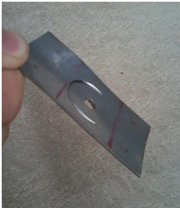
Figura 84 – Resultado da tentativa de furação na chapa de apoio
