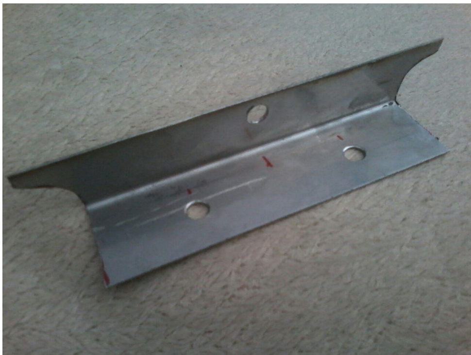
Figura 79 – Cantoneira de suporte do bagageiro e para-lama finalizada
