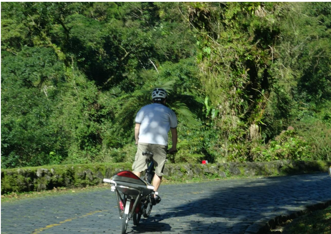
Figura 97 – Teste em trecho pavimentado com paralelepípedos
