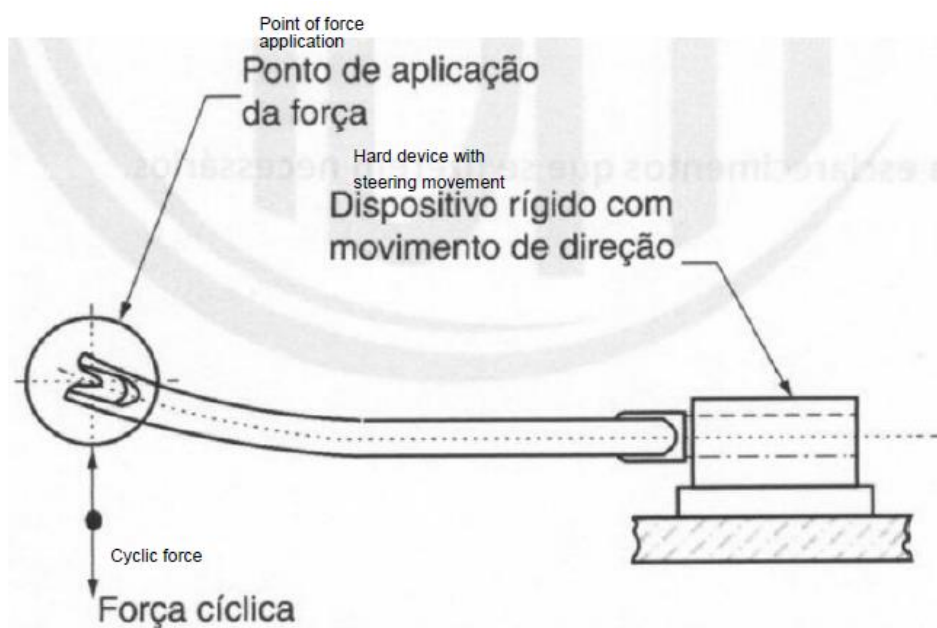
Figura 64 – Condições do teste de fadiga do garfo da bicicleta Fonte: NBR 14714 (2013)
