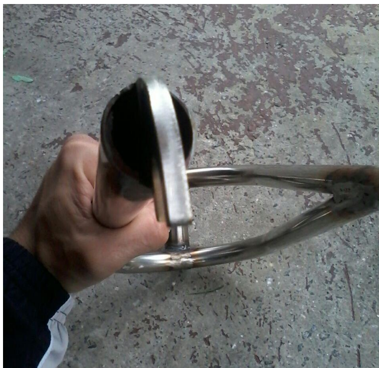
Figura 77 – Detalhe da ausência de furação na gancheira e do tubo aberto
