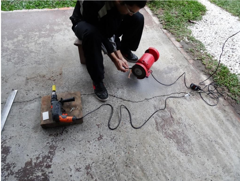
Figura 78 – Utilização do esmeril para acabamento dos cortes de encaixe da cantoneira
